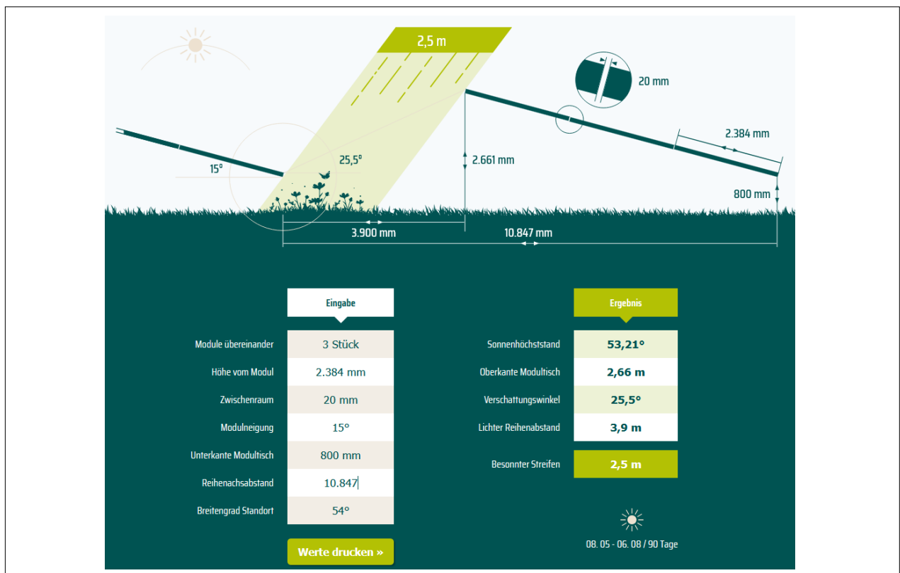
Abbildung 5: beispielhafte Berechnung des besonnten Streifens bei Südausrichtung; Quelle: https://gute-solarparks.de/besonnter-streifen-in-solarparks/
